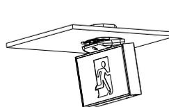
3. Après le raccordement, aligner la glissière en position puis fixer solidement à l'aide de la vis.
