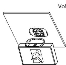
1. Fixer la plaque arrière sur la boîte de jonction au mur.
