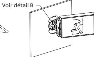
2. Suspendre l'unité à l'aide de la languette et des œillets.
