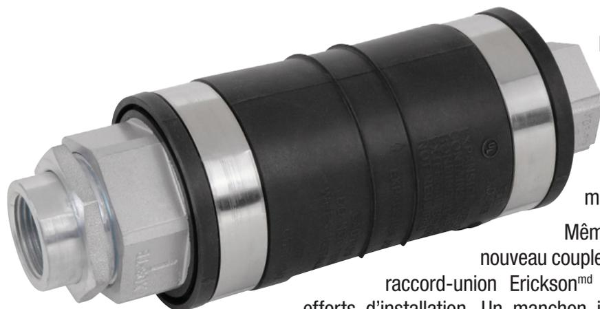
Pour toutes les applications où vous devez joindre deux parcours de conduit et prévoir du mouvement, utilisez le coupleur expansion/déflexion XD. Ce coupleur assure une connexion flexible, étanche à l'eau, et qui résiste aux mouvements axiaux ou parallèles d'un maximum de 3/4 po et aux mouvements angulaires d'un maximum de 30 degrés de sa position normale.
