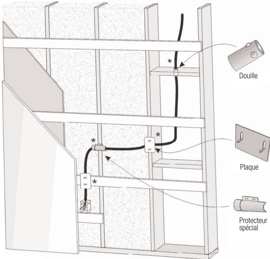
\* Une protection est requise si la distance qui sépare le câble du bord de tout élément de charpente est inférieure à 32 mm.
