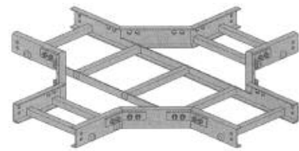
Exemple d'un raccord biseauté
