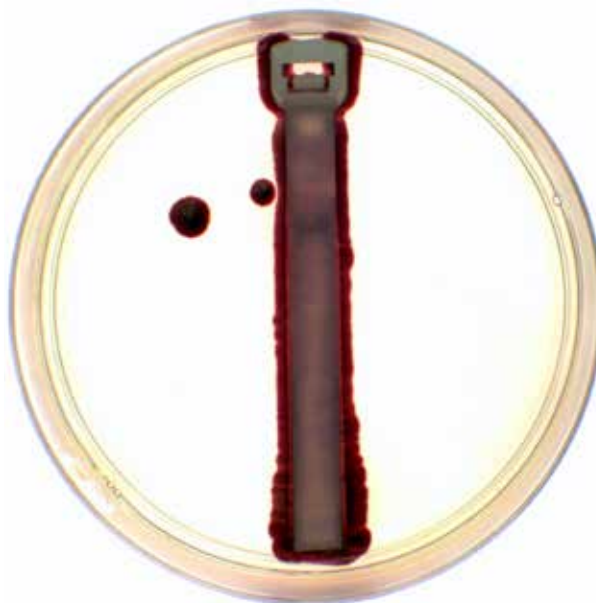
Attache pour câbles standard après une exposition de 24 heures aux bactéries
