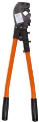
TBM6S Outil manuel avec mécanisme Shure-Stake pour assurer un sertissage complet. Sert aux connecteurs en cuivre d'un maximum de 500 kcmil, en aluminium, de 350 kcmil.
